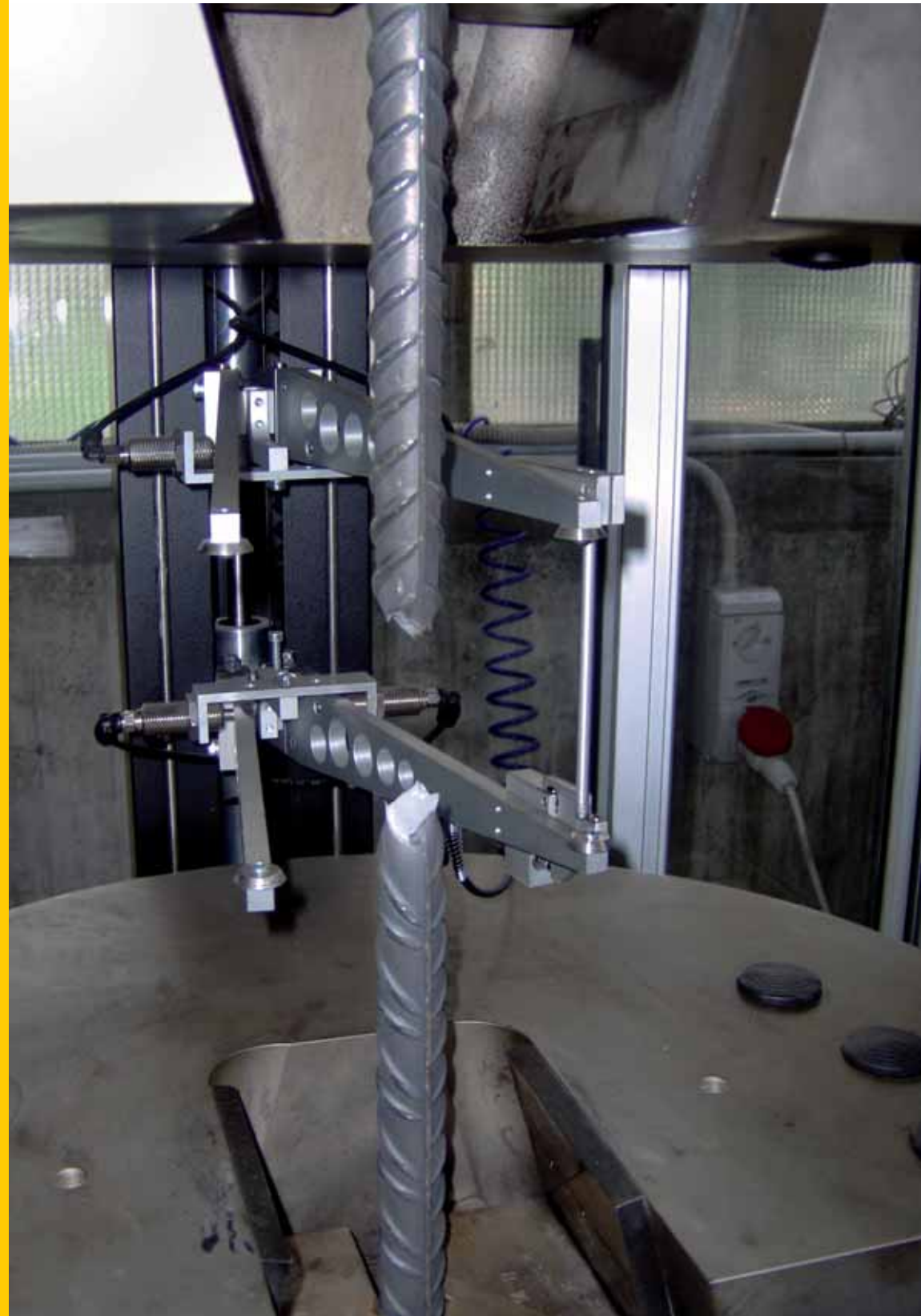
Nella foto: Prova di trazione con estensimetro elettronico
