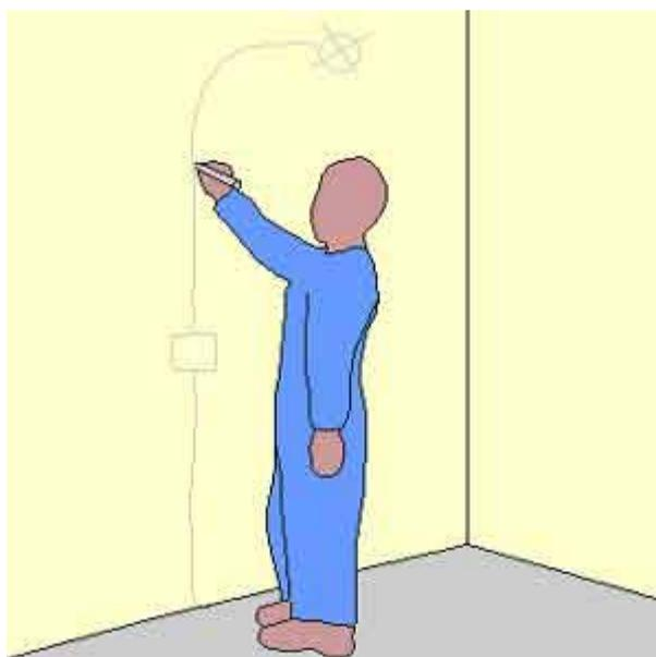
**Fig. 1.1:** Si tracciano sulla parete i percorsi che dovranno assumere le condutture di collegamento. Le condutture dovranno essere posate nelle pareti con percorsi verticali o orizzontali
