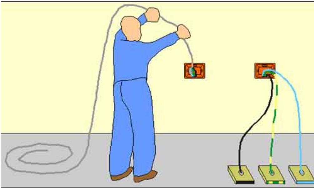
**Collegamento apparecchi** – Si collegano i conduttori agli apparecchi facendo attenzione a non lasciare sbavature di materiale conduttore all'esterno del morsetto di serraggio. Le spellature devono essere effettuate di misura, con l'accortezza che la parte conduttrice sia completamente inserita all'interno del morsetto.
